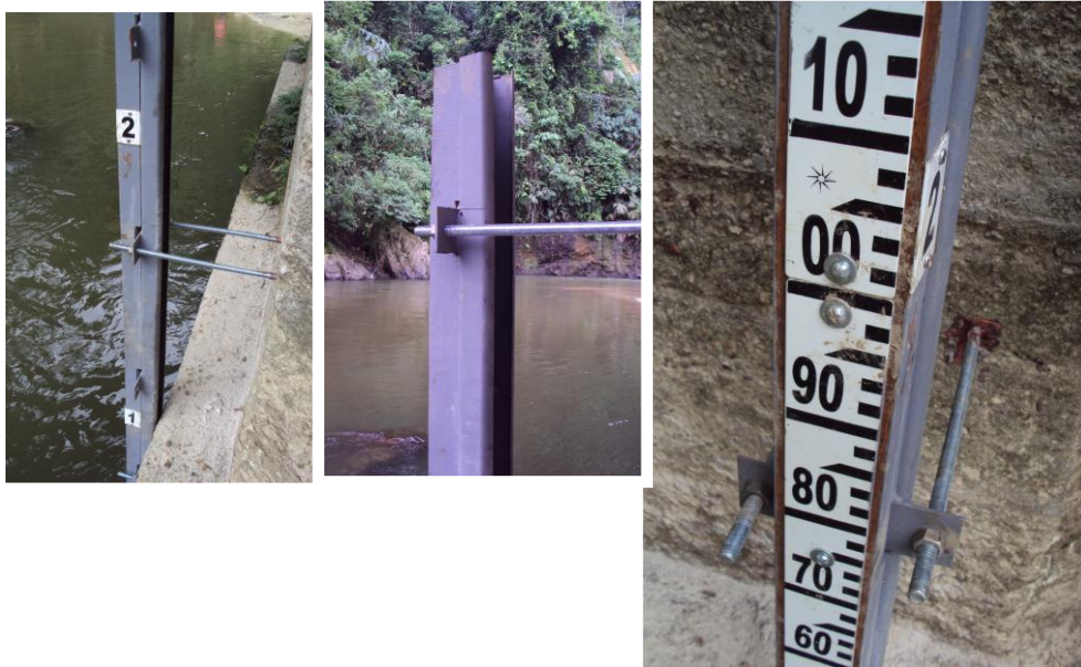
GRAFICO 35. Sistema de anclaje de los limnímetros de las estaciones para la medición de grandes caudales
